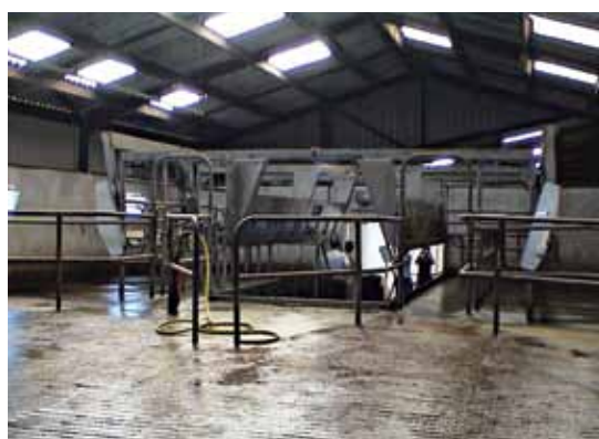
Salle de traite avec deux couloirs retour
