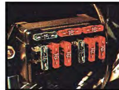
**En cas de remplacement, respecter rigoureusement le calibre d'origine des fusibles.**
