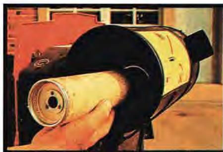
**Lorsqu'il existe un second élément filtrant de sécurité, ne jamais le nettoyer ; il doit être remplacé par un élément neuf.**
