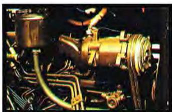
**Contrôler périodiquement la tension de la courroie du groupe de climatisation.**
