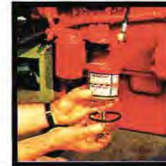
**Les préfiltres et les filtres proprement dits doivent être remplacés périodiquement, en se conformant aux prescriptions du constructeur.**
