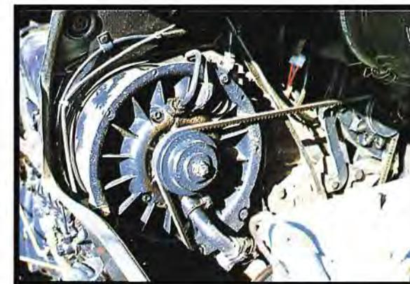
**Vérifier l'état et la tension des courroies de la soufflerie. Ne pas hésiter à les remplacer en cas de doute sur leur état.**
