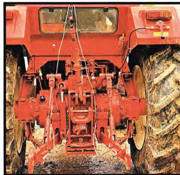
**S'assurer de l'efficacité des verrous d'attelages automatiques (à l'arrière et à l'avant) afin de prévenir tout dételage intempestif lors des rebonds. Faire remplacer les éléments en cas d'usure ou de détérioration.**
