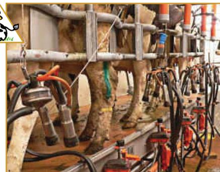
Le support de lavage doit être dans la zone de confort et fonction de la hauteur du quai (pas de contraintes techniques pour surélever le support pliable ou non). Il existe des modèles avec des manchons de lavage souples. Les plateaux de lavage pliants doivent être installés en fonction de la taille du trayeur. Cette implantation évite l'encombrement et l'éloignement par rapport à la mamelle.
