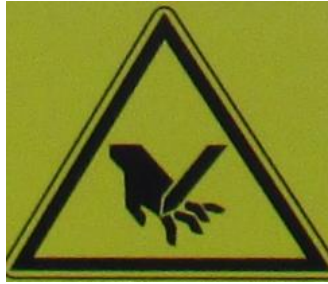
Figure 21 - Pictogramme rappelant le risque de coupure
