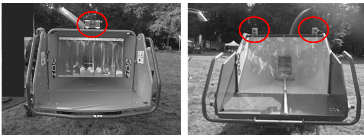
Figure 16 - Exemples de déchiqueteuses équipées de boutons d'arrêt d'urgence en partie haute de la goulotte
