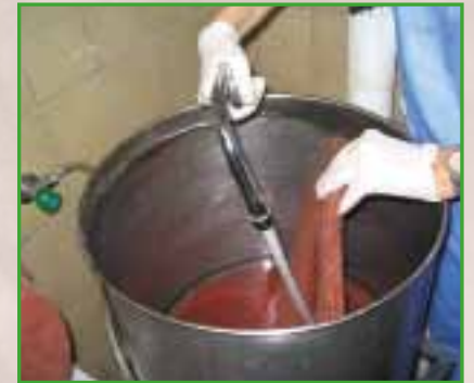
Nouvelle cuve métallique sur un support en hauteur avec roulettes
