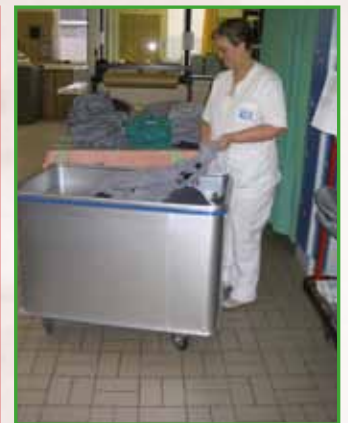
Chariot à linge avec fond à ressort : le linge est saisi en meilleure position
