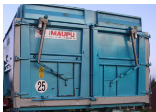
Trappe de vidange à commande électrique sur benne élévatrice
