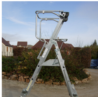
*PIR : Plate-forme Individuelle Roulante réglable en hauteur
