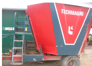
Mélangeuse avec accès et plate-forme sécurisés
