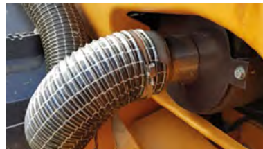
Exemples d'emplacement de percement pour la mesure du débit d'air
