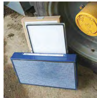
Jeu de 3 filtres 600 x 336 mm a - Préfiltre poussières b - Filtre poussières H13 c - Filtre à charbon actif ABEK
